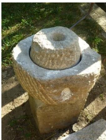
Moulin individuel réalisé en pierre granitique par le mari d'Aurélia, qui est tailleur de pierres. A noter le trou conique sur le dessus pour l'arrivée du grain, ainsi que les sillons sur la partie mobile.
