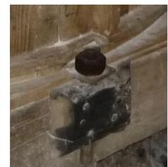
*Avec la pince, il faut régler l'écrou (trois tours) qui commande l'écartement des meules et le réglage de l'écrasement du grain, déterminant la finesse de la mouture.*
