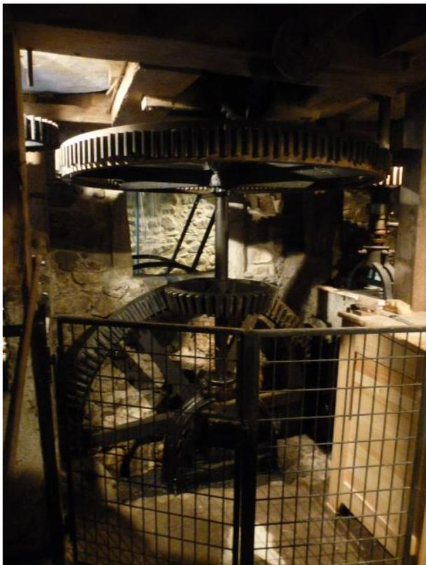
L'arbre de transmission, appelé "hérisson", est en prise directe avec les dérivations sur chacune des deux meules. Il transforme, par une série d'engrenages, le mouvement vertical de la roue en un mouvement horizontal qui entraîne les meules. La vis permet de faire tourner différents appareils à l'aide de courroies.
